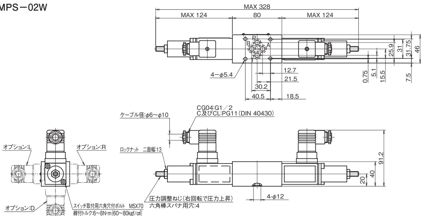
(注) オプション記号 D,L及びRは、スイッチ取付用ボルトを外すことにより向きを変えることができます。ボルトは、指定のトルクで締付けてください。
